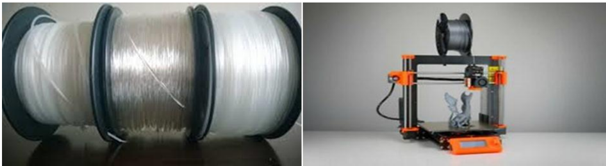
Figure I.23 : PA extrudé couche par couche sur la plateforme d'une imprimante 3D FDM.
