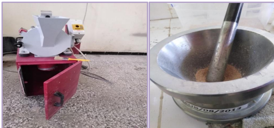
Figure 2- 3 Broyage du sable.
