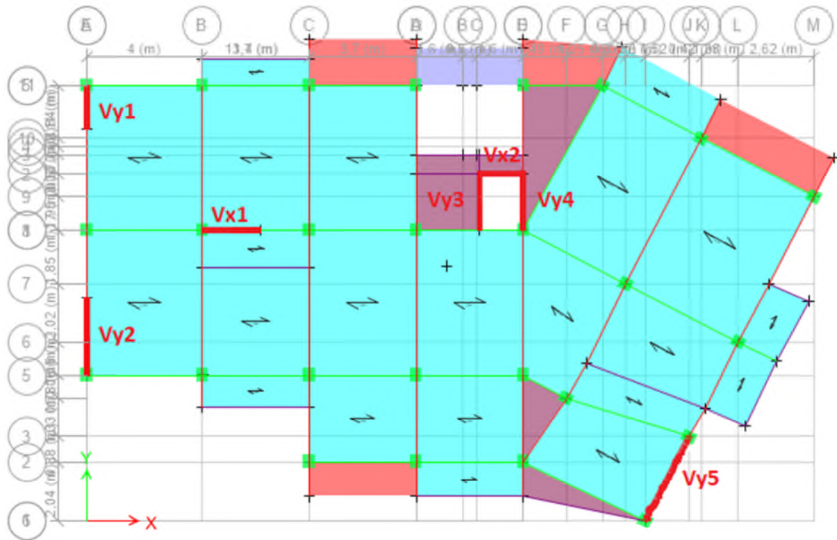
Figure 3.2. Disposition des voiles de contreventement.
