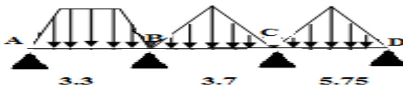
Figure8:répartition des charges selon sens y-y
