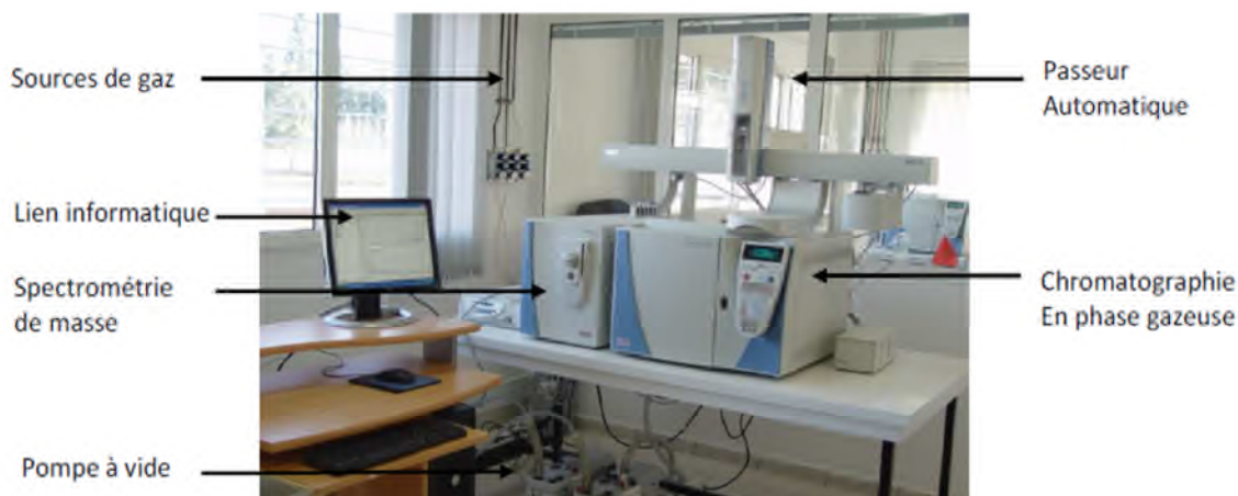
Figure19: Photo d'un Chromatographe en Phase Gazeuse Couplé à un spectromètre de masse (GC/MS).
