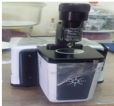
Figure 14 : l'appareil Agilent Technologies Cary 630 FTIR pour l'analyse IR ATR.
