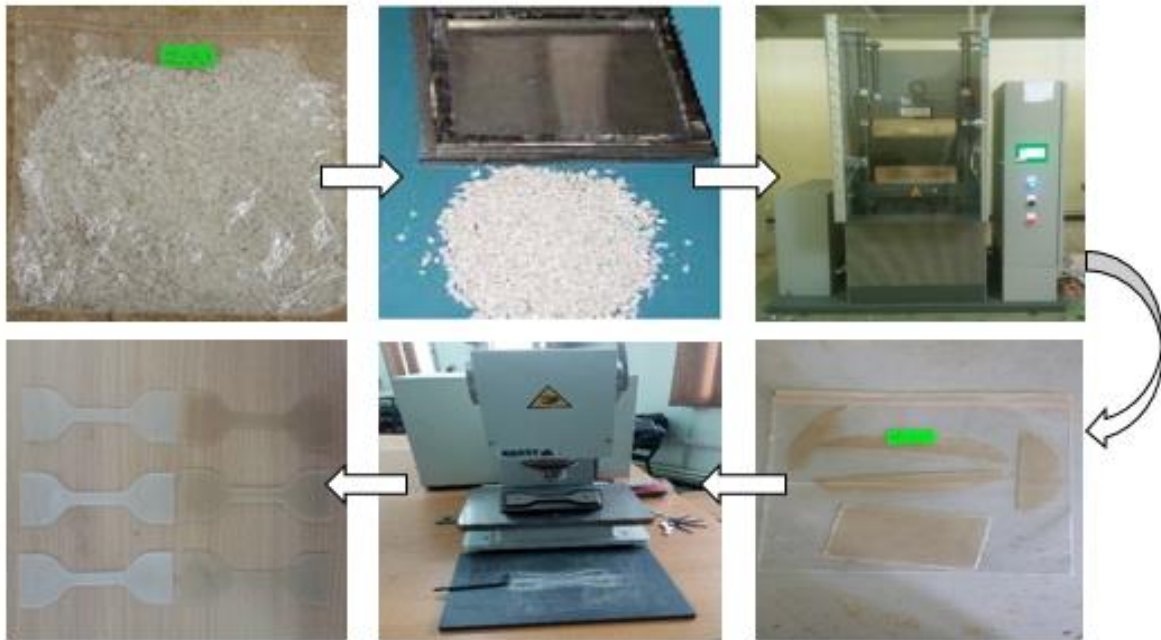
Figure 12: Processus d'obtention des échantillons par pression.
