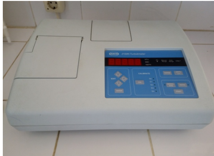
Figure 11 : Turbidimètre HACH 2100N (laboratoire de l’ADE).
