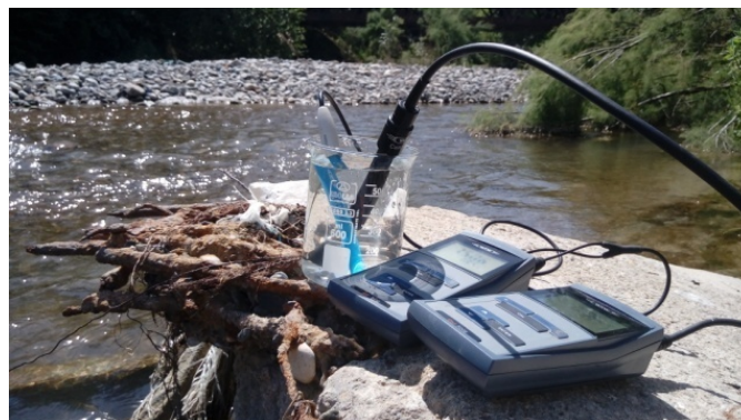
Figure 09 : Mesure du pH et de l'oxygène dissous.
