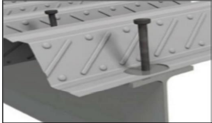
Figure III -25: goujon a tête soudé avec profilé
