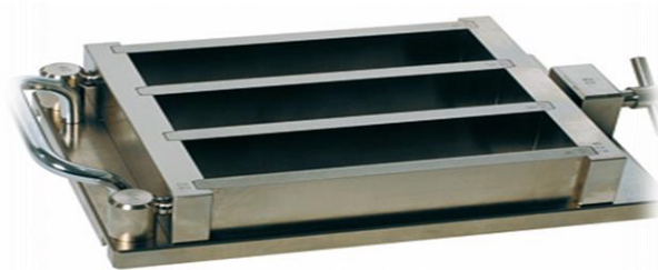
Figure II.20: Moule pour moulage des éprouvettes de mortier
