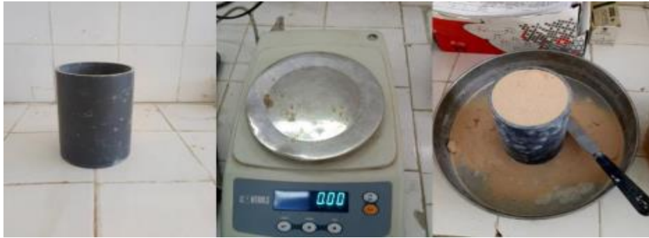
Figure III.18 : l'essai de mesure de la masse volumique apparente.
