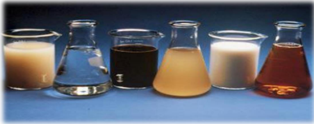
Figure II.17 : Adjuvants liquide de gauche à droite : agent anti-lessivage, réducteur de retrait, réducteur d'eau, agent moussant, inhibiteur de corrosion et agent entraîneur d'air. [68]
