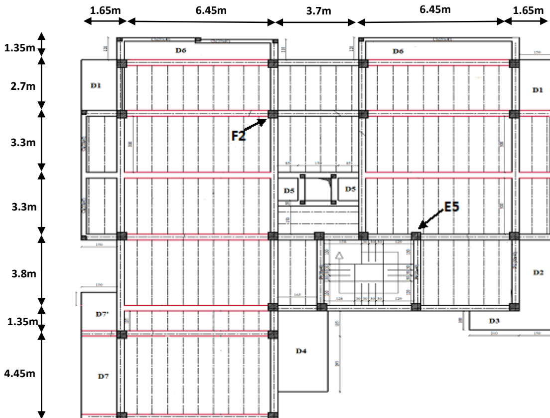
Figure 2.1. Disposition des poutrelles dans tous les niveaux
