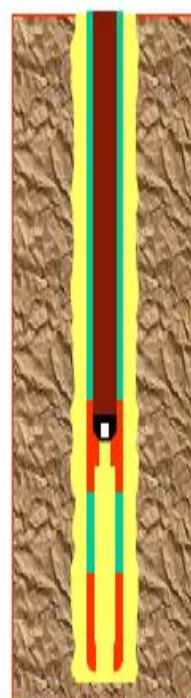
Le bouchon inférieur arrive sur l'anneau
