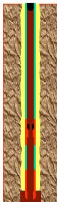
Lancement du bouchon supérieur
