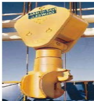
Figure I.8 : Le moufle mobile et le crochet [1].
