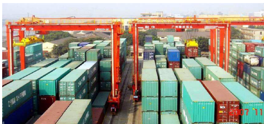
Figure 14 : Pont roulant sur rails au port de salerno en Italie
