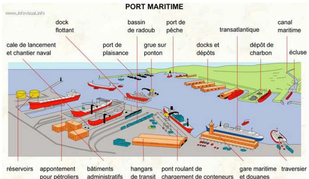
Figure N°02 : Montre les éléments d'un port maritime
