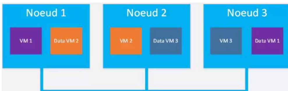
Figure 22 : Schéma expliquant la nécessité d'un minimum de 10GbE en bande passante.
