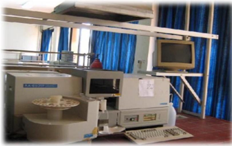
**Figure II.1.**Appareil Spectrophotométrie d'absorption atomique (SAA).
