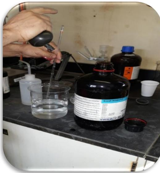
Figure II.16 : Préparation de la solution aurifère [Photo prise].
