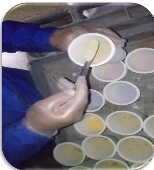
*Figure A.4 : Versement du minerai + fondants dans les creusets [Photo prise].*
