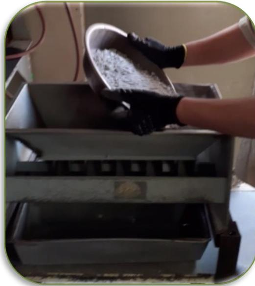
*Figure II.4 : Opération d'homogénéisation par le diviseur à riffle [Photo prise].*
