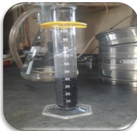
Figure II.15 : Essai de la porosité apparente [Photo prise].
