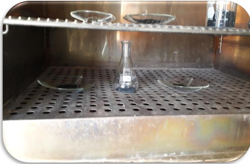
Figure II.12 : Echantillons de charbon actif dans l'étuve [Photo prise].
