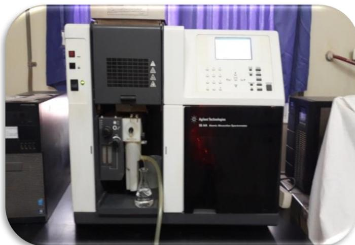
*Figure A.1 : Spectromètre d'absorption atomique du laboratoire d'Amesmassa [Photo prise].*
