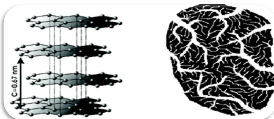
Figure I.3 : Structure cristallographique du CA et représentation schématisée de sa structure poreuse plane [12].
