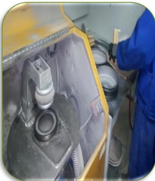
*Figure II.5 : Pulvérisateur du laboratoire d'Amesmassa [Photo prise].*
