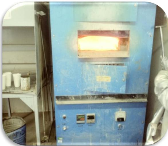
*Figure A.6 : dépôt des creusets dans le four de fusion [Photo prise].*
