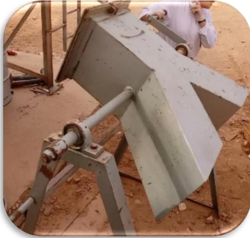
*Figure II.7 : Mélangeur d'échantillons [Photo prise].*
