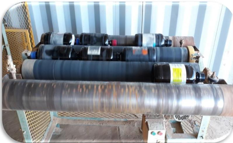
*Figure A.11 : Dispositif de rotation des bouteilles roulantes [Photo prise].*
