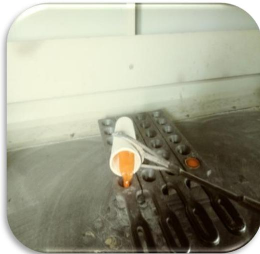
*Figure A.7 : Versement du fondant dans les moules [Photo prise].*
