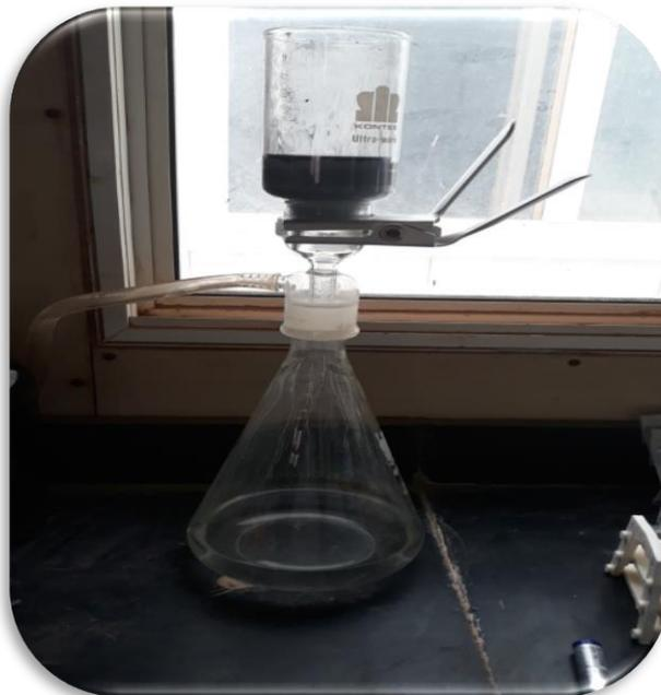
*Figure A.13 : Dispositif de la filtration [Photo prise].*
