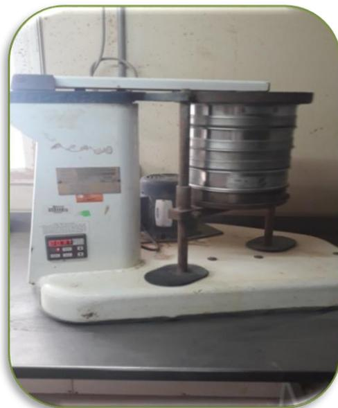
*Figure II.6 : Tamiseuse du laboratoire d'Amesmassa [Photo prise].*
