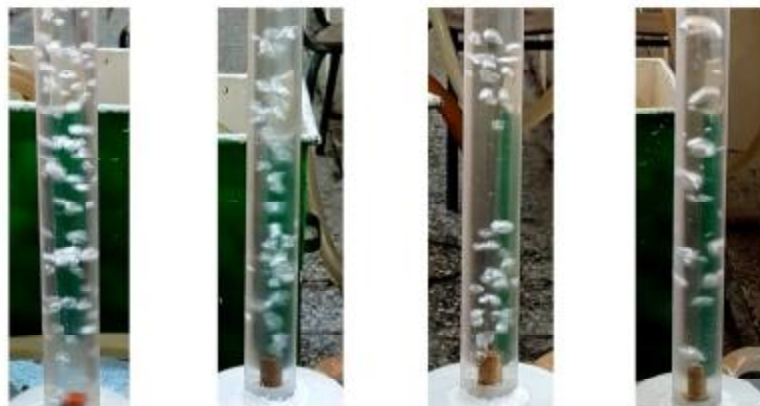
Figure III.1 : Photographie du régime à bulles obtenus par les auteurs
