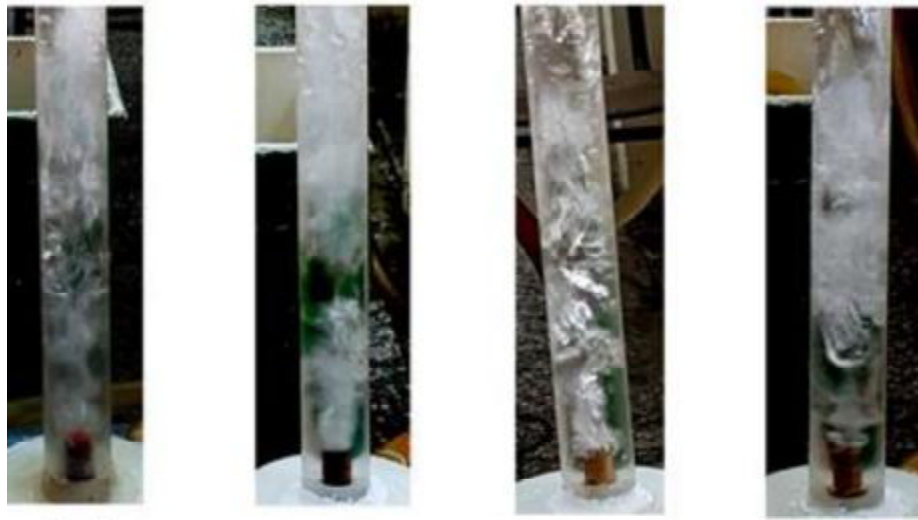
Figure III.3 : Photographie du régime turbulent baratté obtenus par les auteurs
