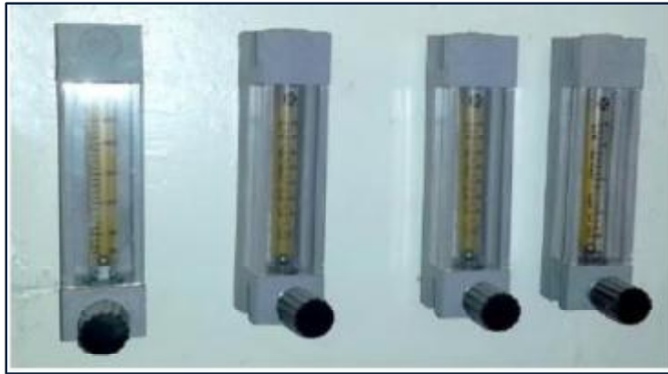
Figure II.8 : Débitmètres à air montés en parallèle
