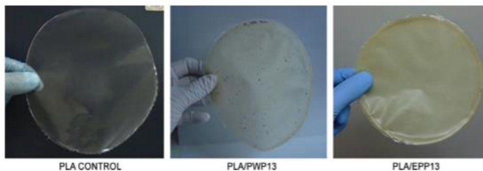
Figure III.1. Aspects visuels du film PLA (témoin) et des AF avec PBP (13%) et EEP (13%) obtenus par voie casting.
