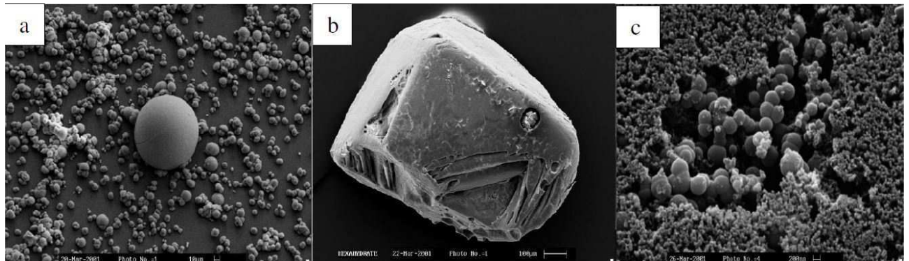
Figure A.II.3. (a) photo MEB du carbonate de calcium amorphe. (b) photo MEB du carbonate de calcium monohydraté. (c) photo MEB du carbonate de calcium hexahydraté
