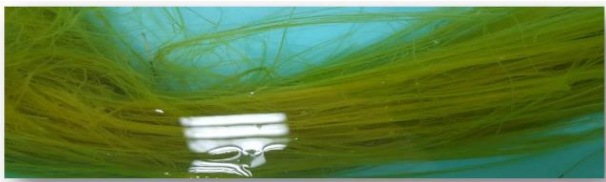
Figure I.18 : Rouissage chimique de fibre d'Alfa [80]
