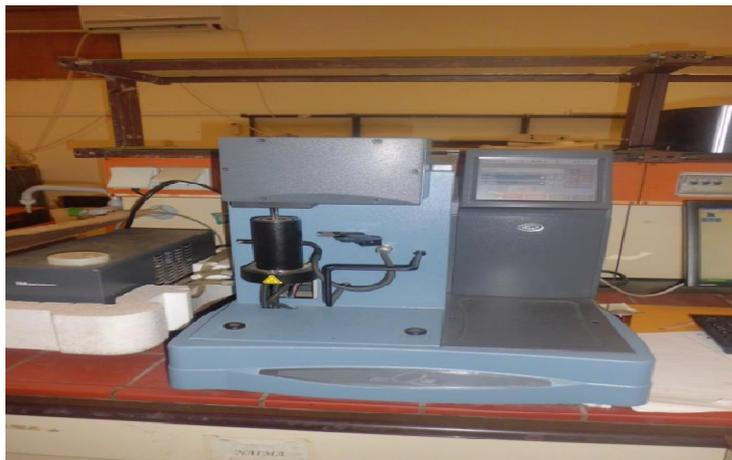
**Figure II.6** .La thermogravimétrie ATG
