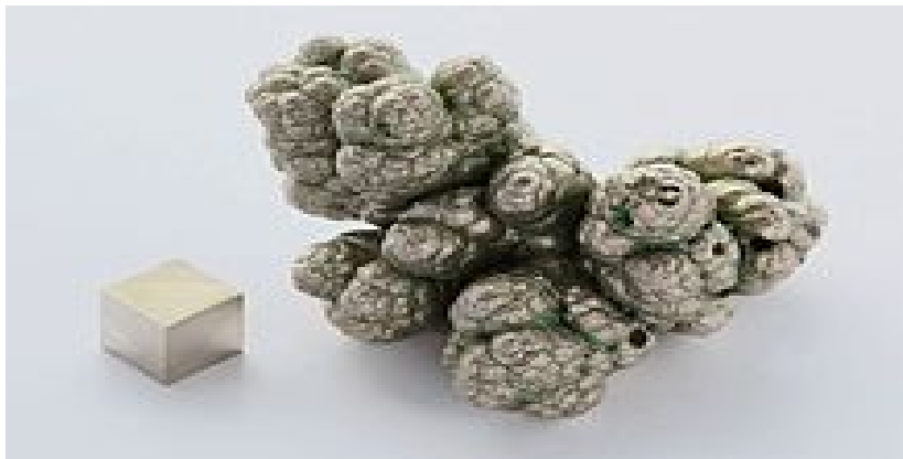
Figure I.2. Nodule de nickel pur (99,9 %), raffiné par électrolyse, à côté d'un cube d'1 cm 3 .
