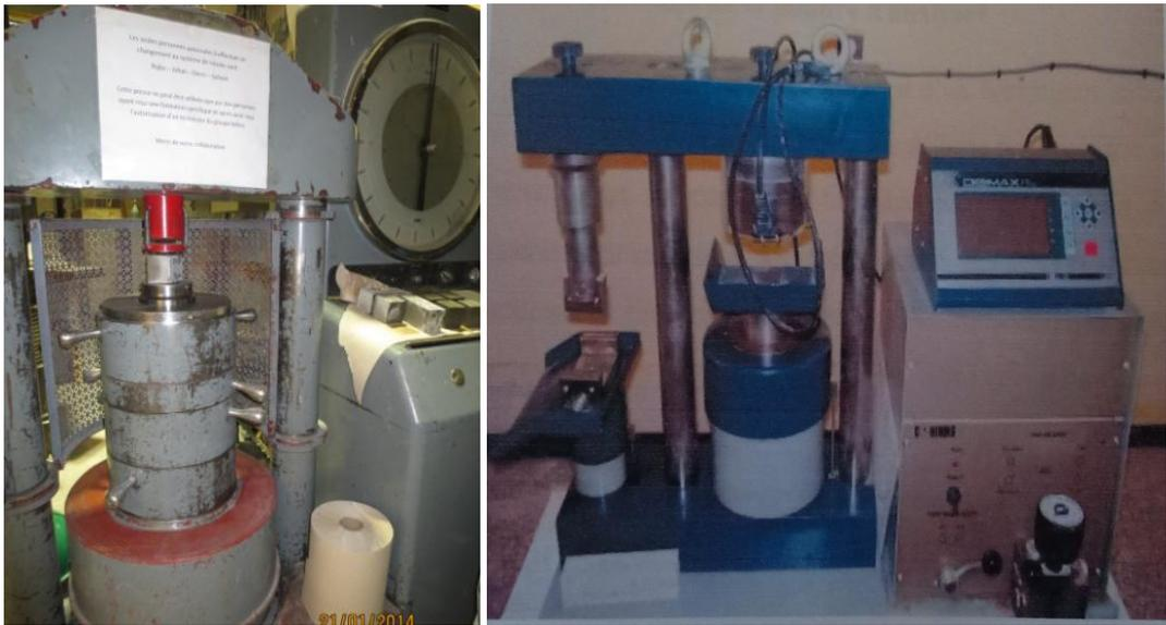
**Figure II-5 :** Appareillage d’essai de résistance à la compression (BALAGUAR.Pascual, 2014)
