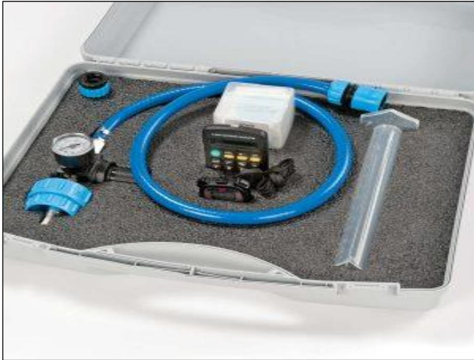
Figure 13. Dispositif de mesure du SDI [10]
