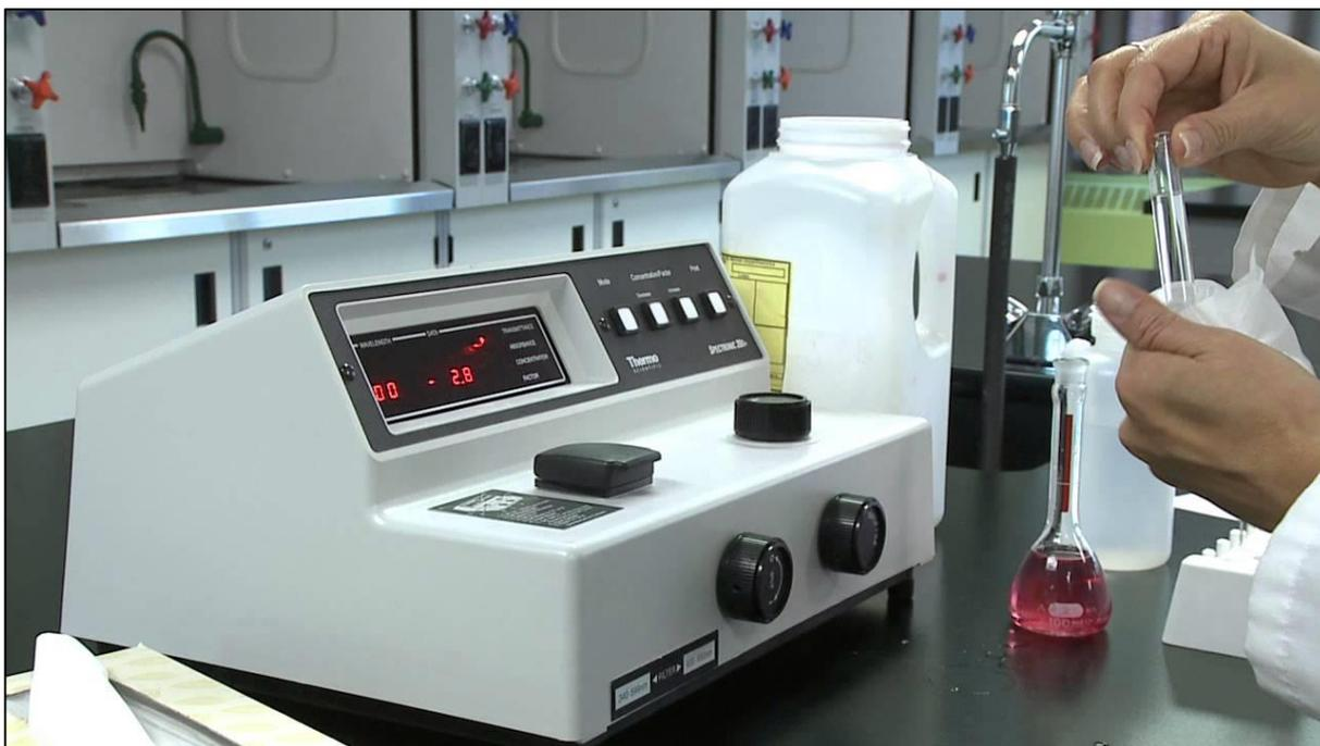
Figure 27. Illustration d'un spectrophotomètre UV- Visible
