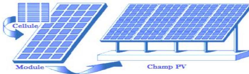
Figure I.8 De cellule au module au générateur photovoltaïque
