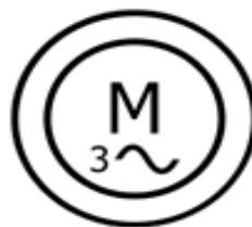
Figure III.4 Symbole moteur électrique.
