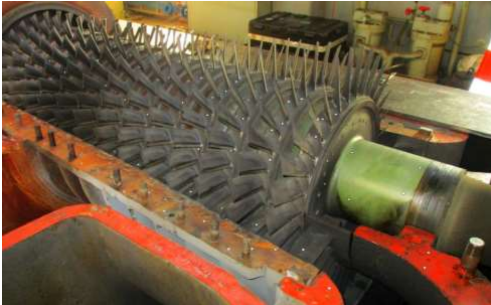
Figure II.8 schéma d'un compresseur axial
