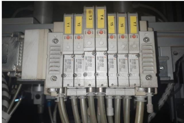
**Figure 1.17 :** Module d'électrovanne
