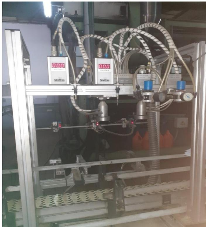
**Figure 1.1 : Testeuse d'étanchéité S-LT-10-2-E 5L PEHD**
