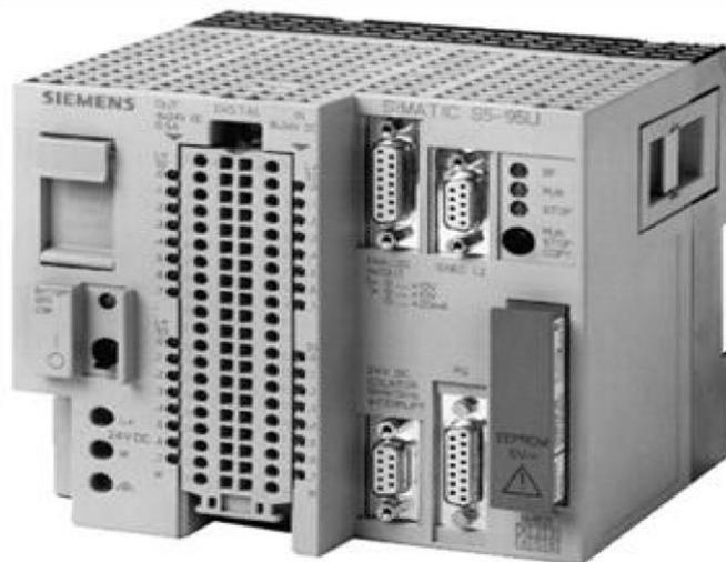
Figure III.1 : Automate-SIEMENS-S5-95U. [17]
