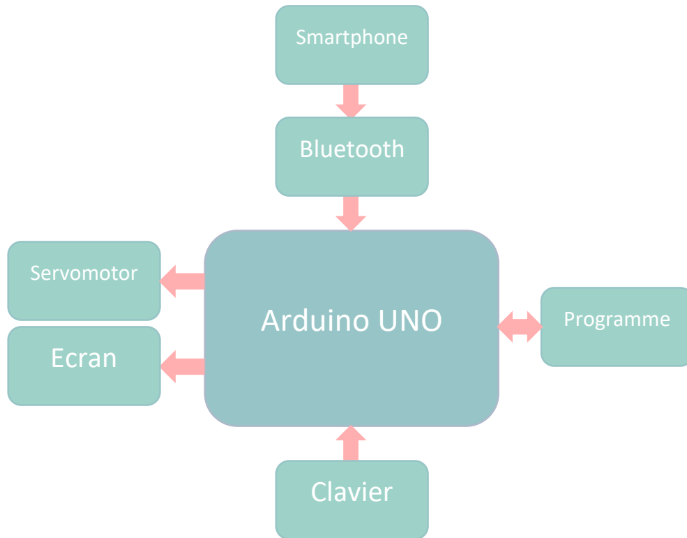
Fig.3. 18. Schéma synoptique de la carte UNO.
