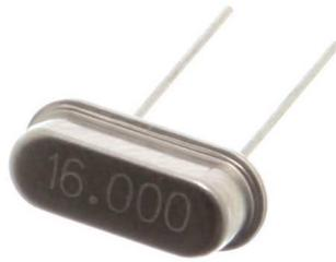
FIGURE IV.3 – Représentations d'un quartz 16MHZ.
