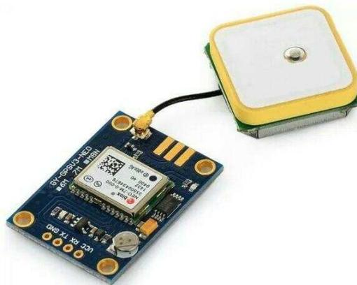
FIGURE II.2 – MODULE GPS NEO-6M [8].
