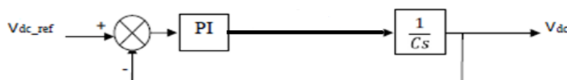
Figure III.7 Schéma fonctionnel pour la boucle de réglage de la tension du bus continu.
