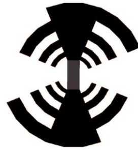
(b) Antenne log périodique circulaire.
