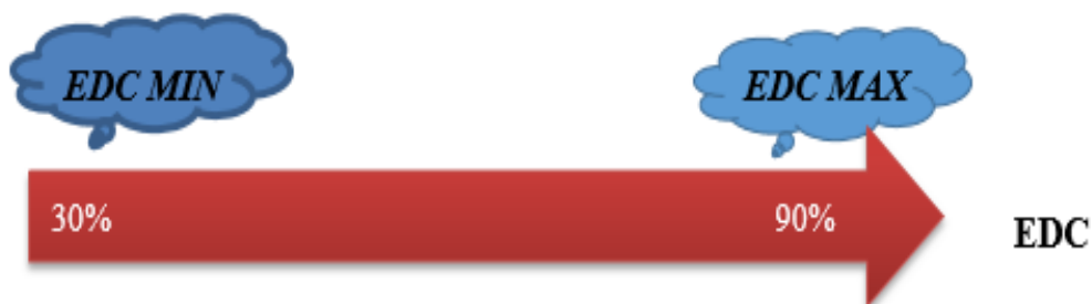
Fig. III.3 Plage de fonctionnement autorisé pour les batteries
