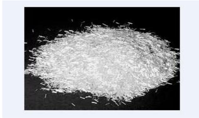
**Figure I.5** Fibres de verre courtes.
