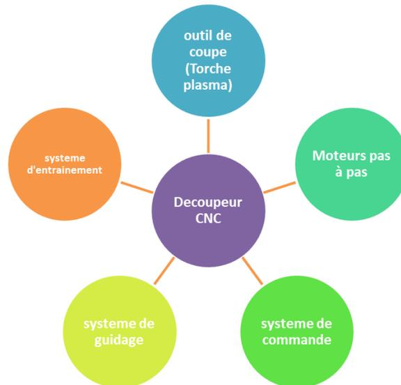
**Figure II-1 : Schémas des constituants de la machine**
