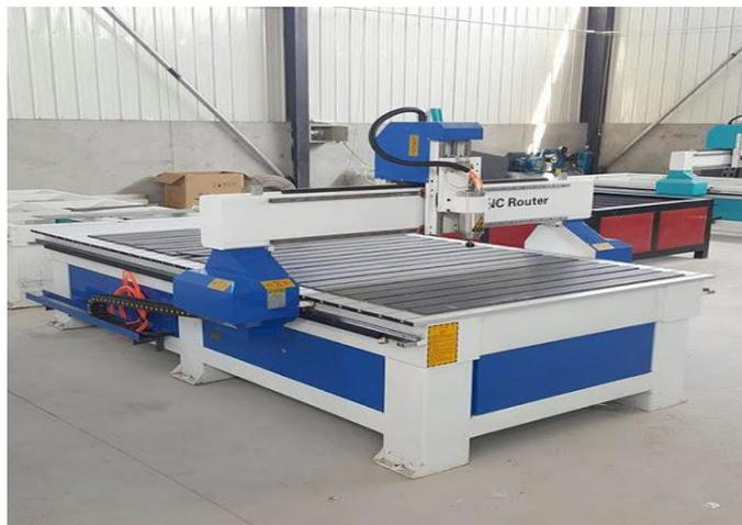
**Figure I-1 : Machine CNC à trois axes (CNC Router)**
