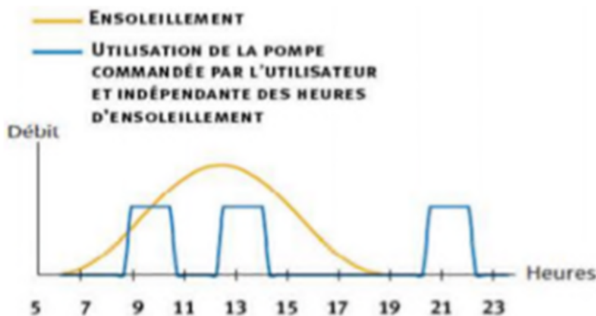
Fig. (I.12) : Caractéristique du pompage avec batteries [18].
