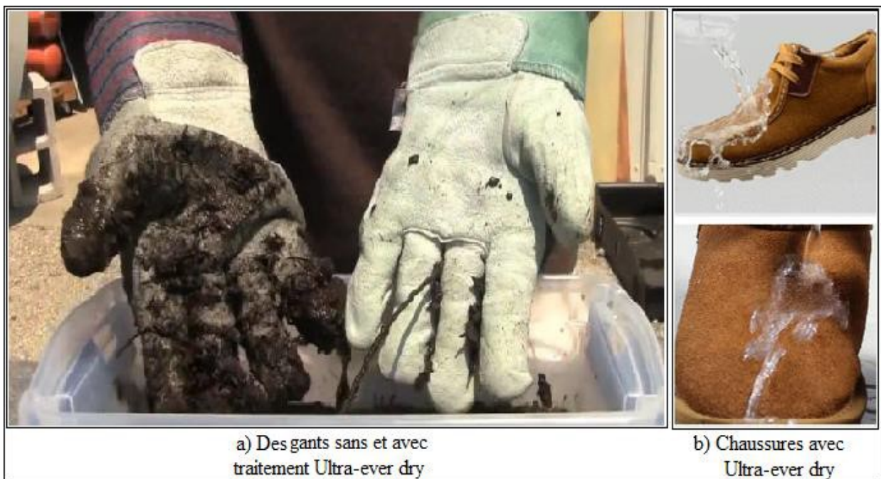
Fig. I. 18: Traitement Ultra-Ever dry sur des gants et des chaussures [41]
