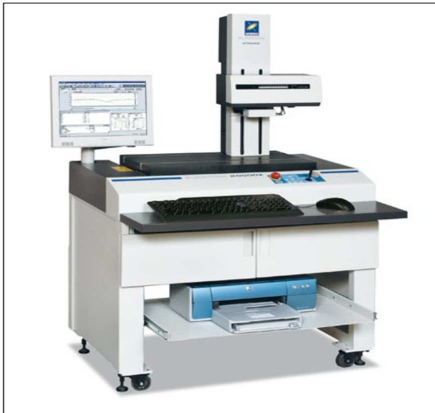
Fig. III. 3: Photo d'un profilomètre du laboratoire de HT de Zittau (Allemagne)
