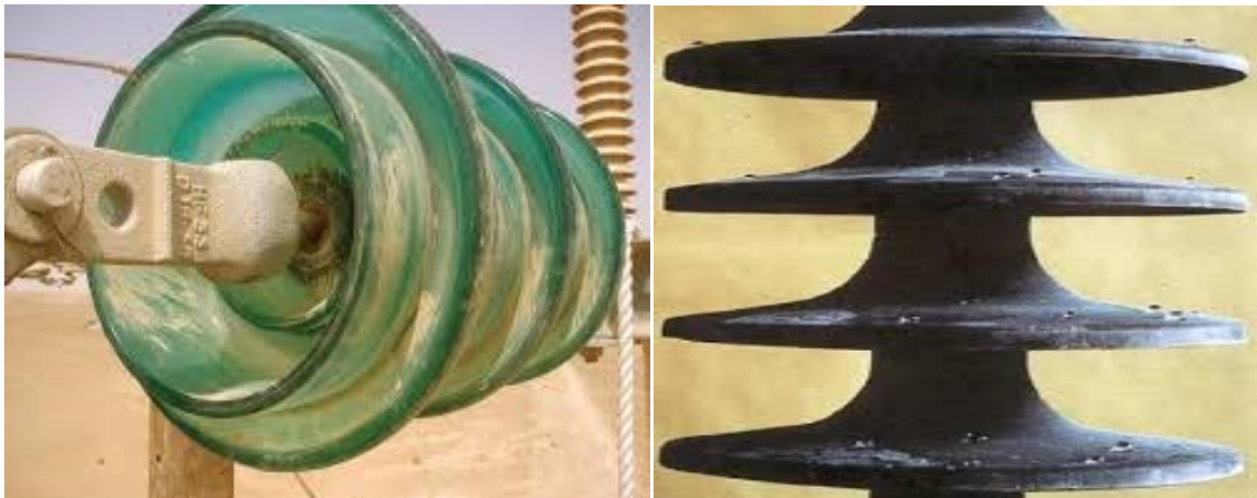
Fig. II. 1: Couche de pollution sur des isolateurs
