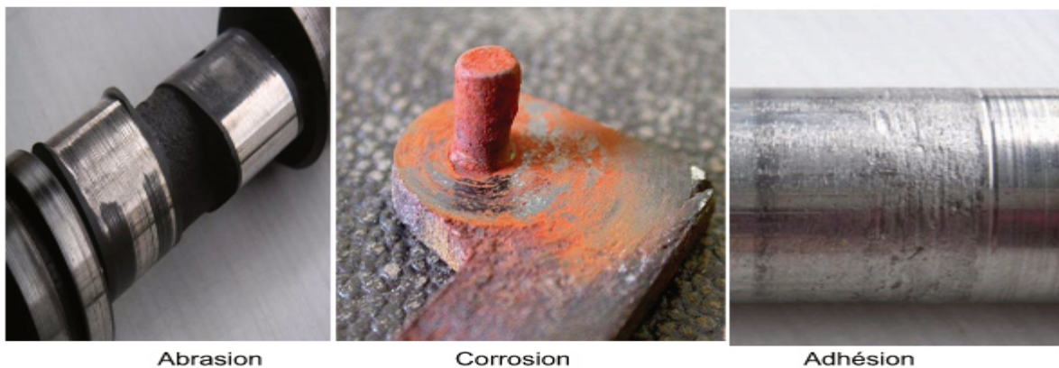
Figure II.1 : Exemples de surfaces usées par différents mécanismes.
