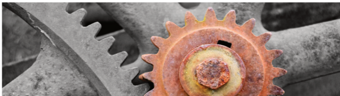
Figure II.4 : Corrosion d'un engrenage
