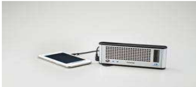
Figure II.28: Application portable d'une pile à combustible [55].
