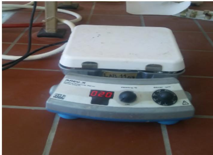
**Figure I.1** : Photo de la plaque chauffante avec agitateur magnétique.
