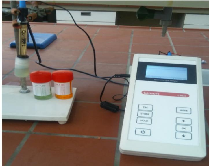
**Figure I.4 :** Photo d'un pH mètre.
