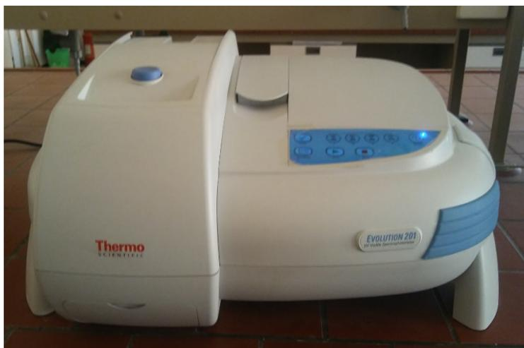
**Figure I.6:** Photo d'un spectrophotomètre UV-Visible.
