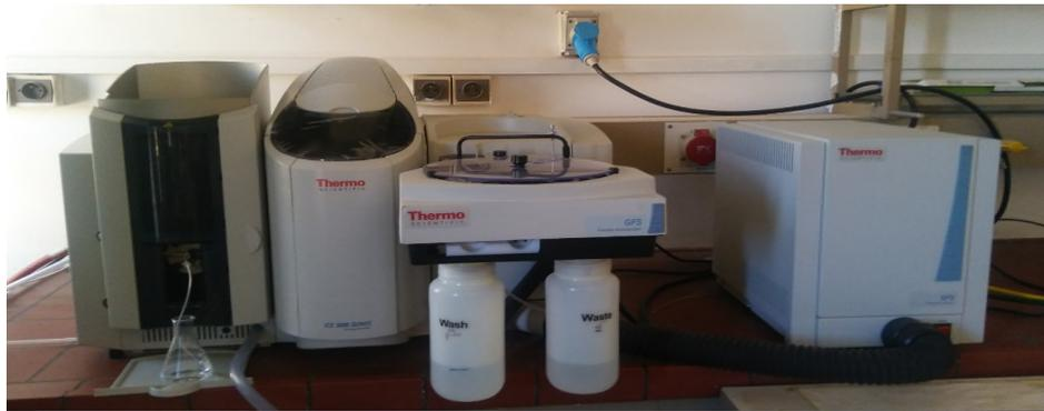
**Figure I.6:** Photo d'un spectrophotomètre d'Absorption Atomique
