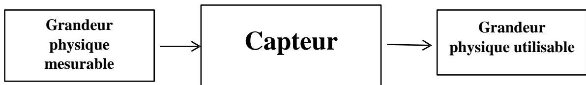
Figure I.9 : Schéma fonctionnel d'un capteur
