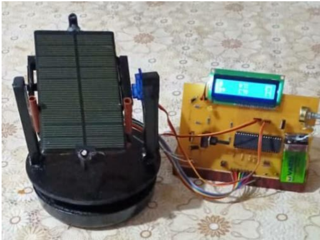
Figure III.14 : Suiveur solaire à deux axes et système de stockage d'énergie
