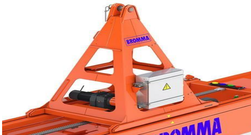
Figure 12 : Armoire électrique dans la tour du Spreader
