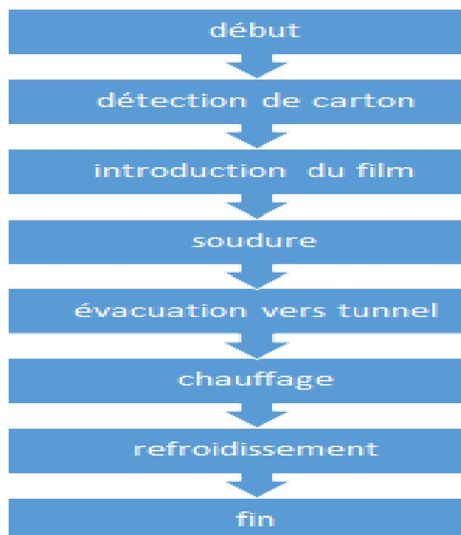
Au cours de production si aucun carton n'est présenté sur le tapis 1, le moteur KM8 est arrêté et le moteur KM1 reste actionner pendant 15 secondes pour assurer l'évacuation des cartons vers la sortie du tunnel. Apes la temporisation, si le commutateur est en mode (cy/cy) va dés-actionner tous les moteurs et il retourne vers la situation initiale.
