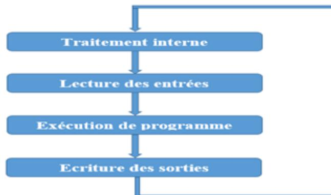
*Figure I.4 : Fonctionnement cyclique d'un automate.*
