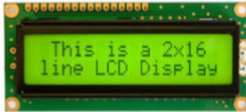
Figure II.9 : Afficheur LCD avec 2 lignes de 16 caractères.
