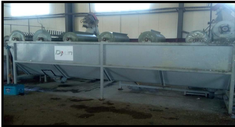
Figure III.20 : Bassin de lavage et de séparation.
