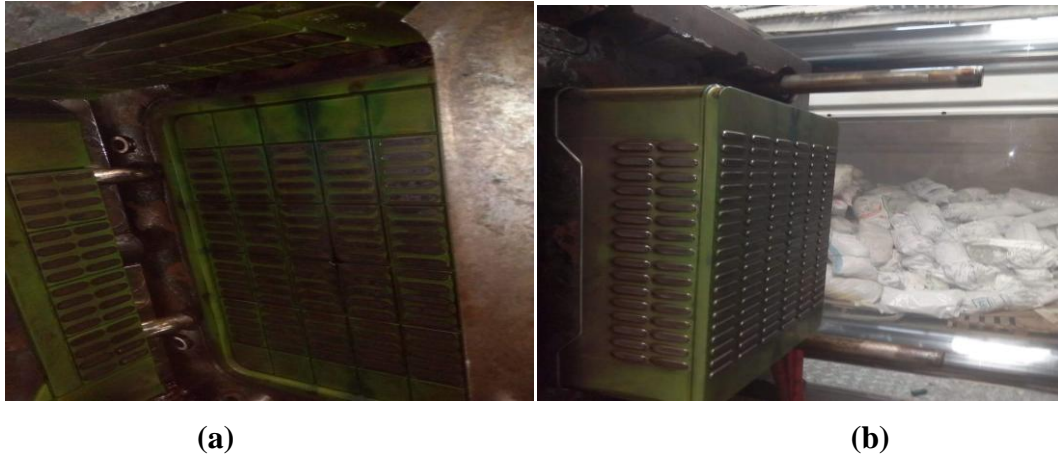
Figure III.36 : Le moule de fabrication des caisses qui constitue d'une partie fixe (a) et une partie mobile(b)
