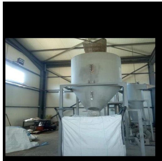
Figure III.23: Tête de récupération des Paillettes.
