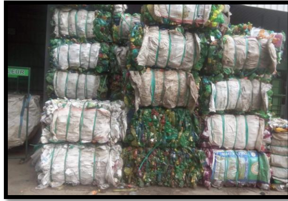
Figure III.11 : Les déchets plastiques stockés sous forme de balles.
