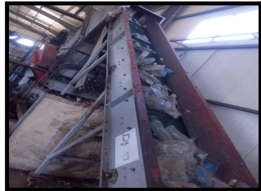
Figure III.14 : Le tapis incliné d'aimantation.
