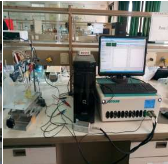
Figure. II.13 : Dispositif expérimentales AutoLab de mesure de l'impédance électrochimique
