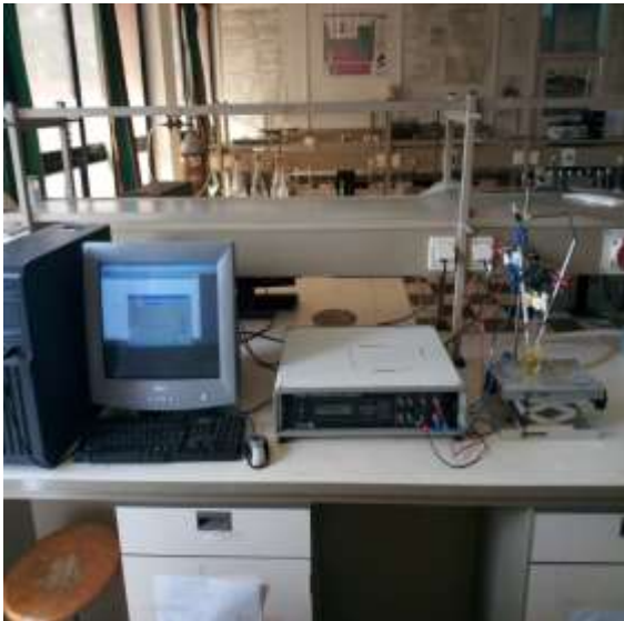
Figure II.12 :Dispositif expérimentales de mesure potentiodynamique, potentiostatique et galvanostatique.
