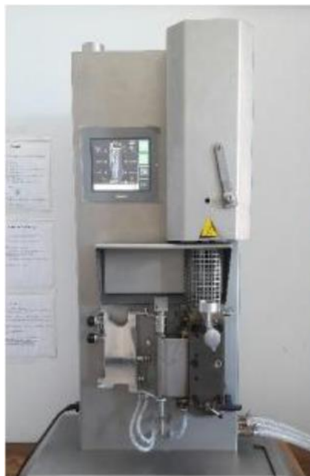
Figure 0III. 5: Mini extrudeuse bi-vis.
