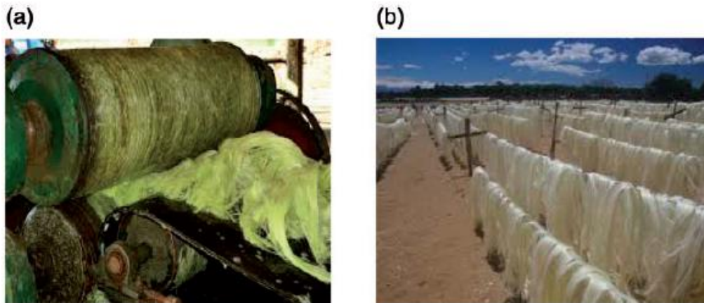
Figure II. 4: extraction des fibres de sisal (a) et séchage (b). [34]
