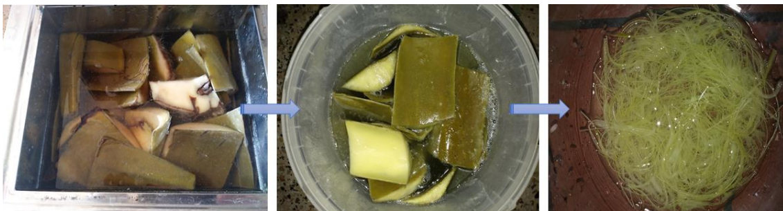
Figure 0III. 3: Illustration du protocole d'extraction des fibres.
