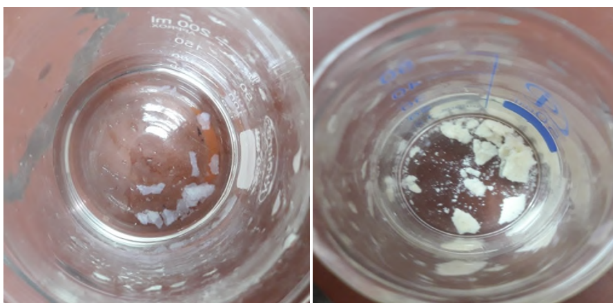
Figure 25 : Les films (amidon extrait, maïs brut) après le test d'absorption en eau
