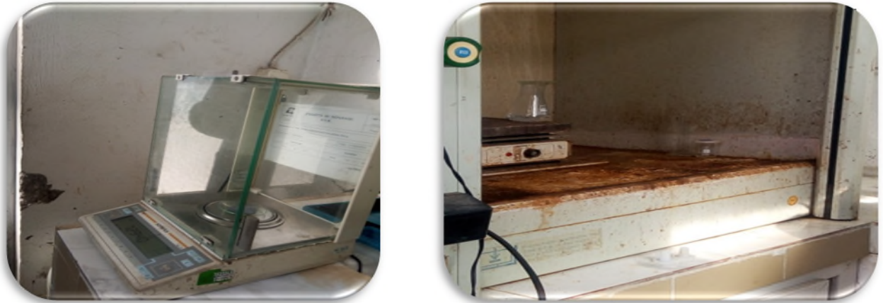
Figure 2.18 : (a) Balance analytique. (b) la hotte et le four pour chauffer l'échantillon.
