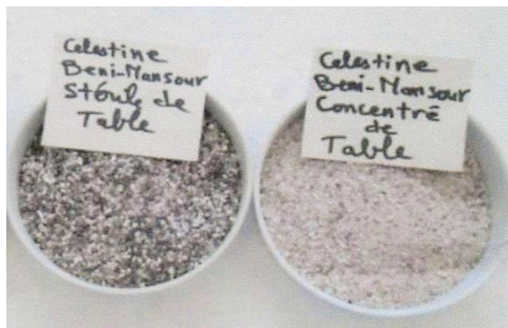
Figure II-13 : Aspect du concentré marchand et des rejets de table, granulométrie : 0-2mm.
