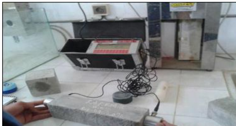
Figure II.13: Appareil de détermination de la résistance à la ségrégation par les ultrasons
