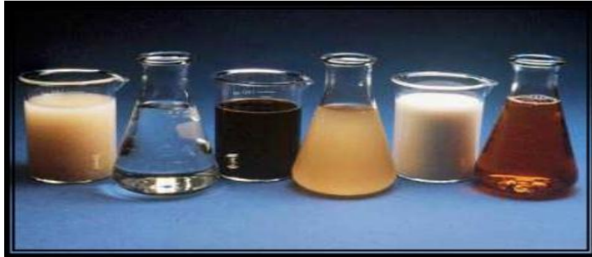
Figure. I.4 : Adjuvants liquides de gauche à droite : agent anti-lessivage, réducteur de retrait, réducteur d'eau, agent moussant, inhibiteur de corrosion et agent entraîneur d'air.
